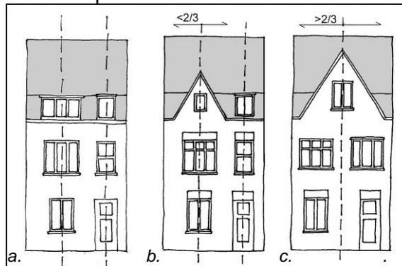
Figure 9 : Combinaisons possibles des lucarnes pour les toitures mansardées
